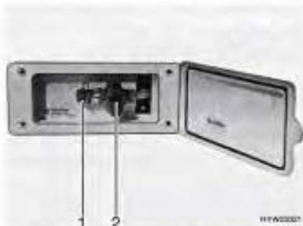
Fig. 112 Raccordement externe de gaz avec robinet d'arrêt de gaz fermé
