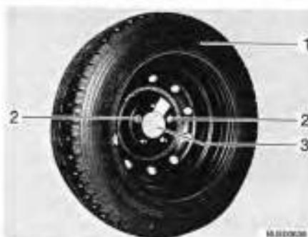
Fig. 223 Etrier de roue de secours dans le garage arrière
