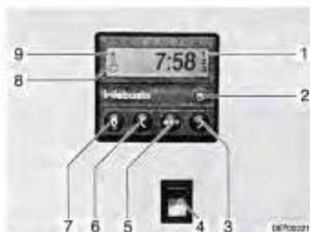
Fig. 145 Unité de commande pour le chauffage d'appoint
