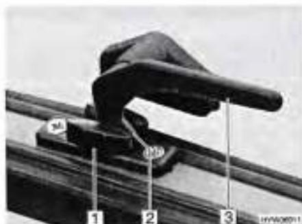
Fig. 63 Levier de verrouillage en position "Aération permanente"
