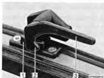
Fig. 61 Levier de verrouillage en position "Fermé"
