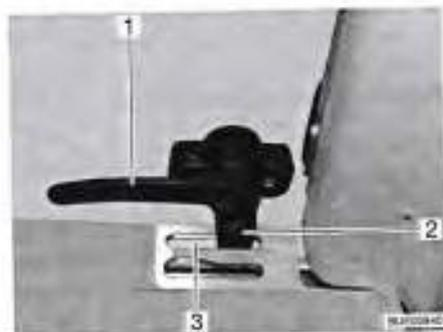
Fig. 78 Levier de verrouillage avant en position "Ventilation"
