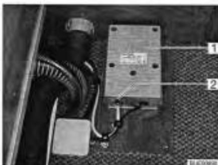
Fig. 146 Transformateur du chauffage électrique du plancher
