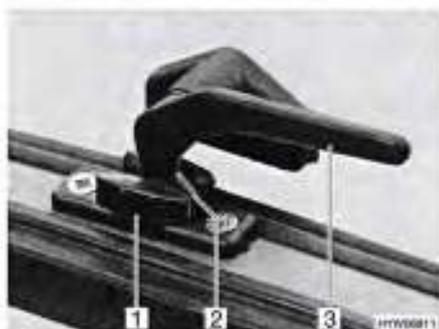
Fig. 60 Levier de verrouillage en position "Aération permanente"
