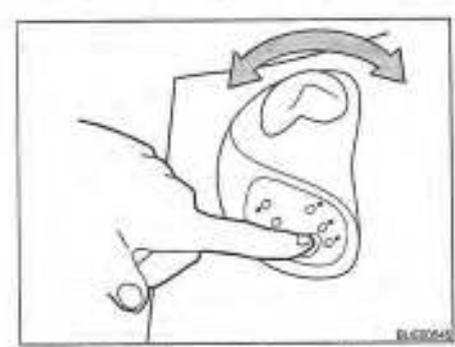
Fig. 202 Actionner la chasse d'eau
