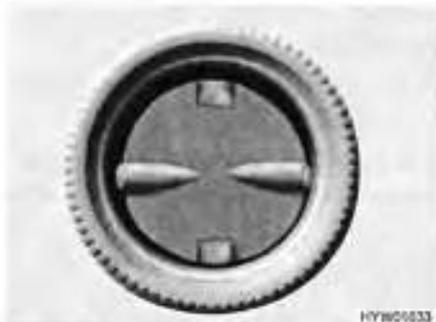
Fig. 138 Buse de sortie d'air
